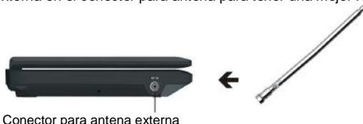
Conector para antena externa
